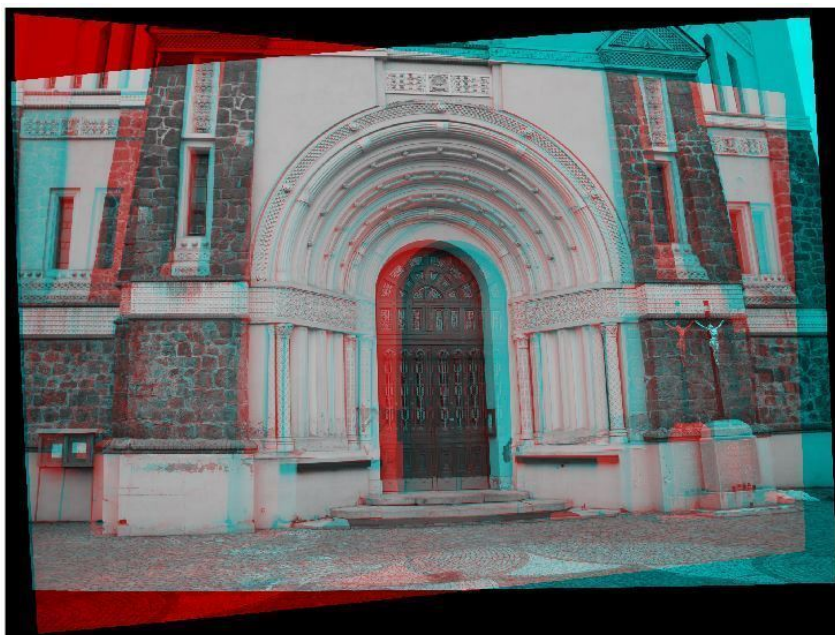
Obrázek 6.2: Rektifikace obrazů do společné roviny.
